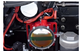
Automatisches Schmierölbetankungssystem Automatic lube oil refuelling system
