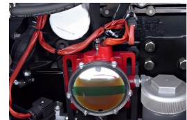
Automatisches Schmierölbetankungssystem Automatic lube oil refuelling system
