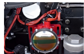
Automatisches Schmierölbetankungssystem Automatic lube oil refuelling system
